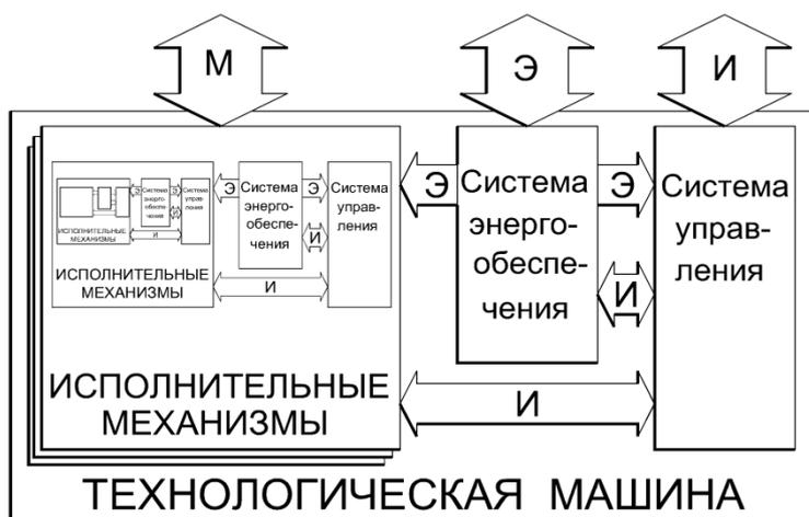
Рис. В1. Состав технологической машины
