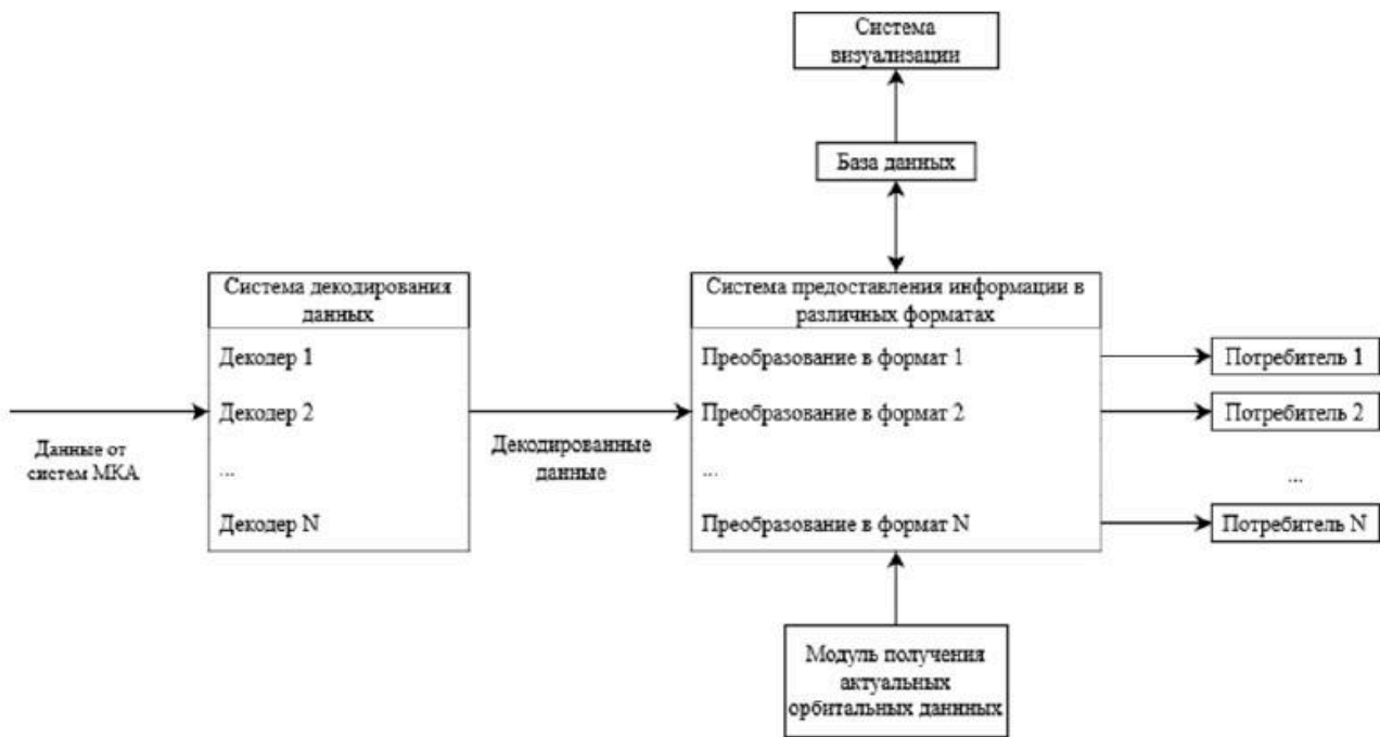
Схема взаимодействия элементов программного комплекса
