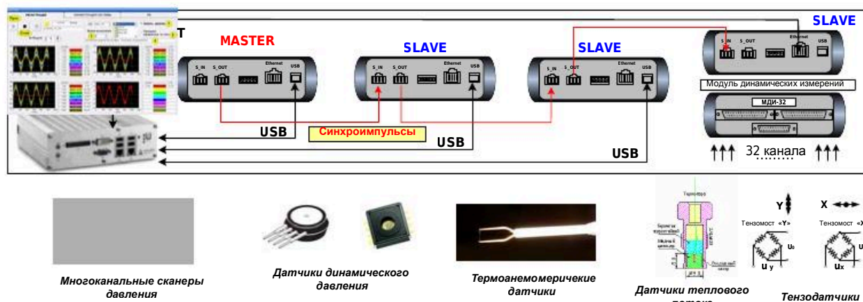
Схема кластера системы динамических измерений
