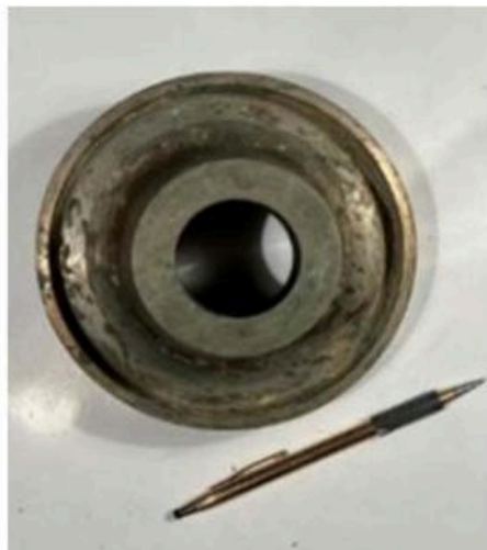
Деталь блока управления полетом ЛА, изготовленная из псевдосплава ВНДС-1
