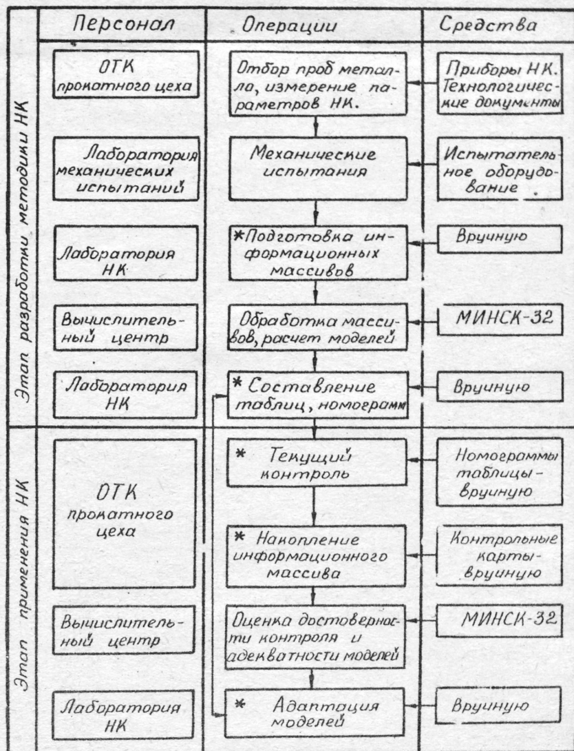
Рис. 3. Система информационного обеспечения НК на Череповецком металлургическом заводе. Звездочками отмечены операции, которые автоматизируются после внедрения микро-ЭВМ.
