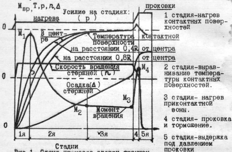
Рис 1. Схема процесса сварки трением быстрорежущих сталей с конструкционными.
