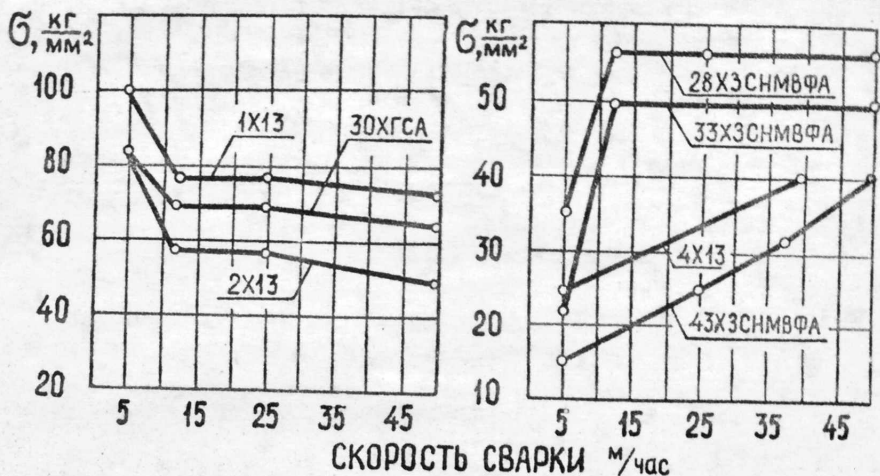
Рис. 2. Влияние скорости сварки на сопротивляемость металла шва образованию холодных трещин для различных сталей
