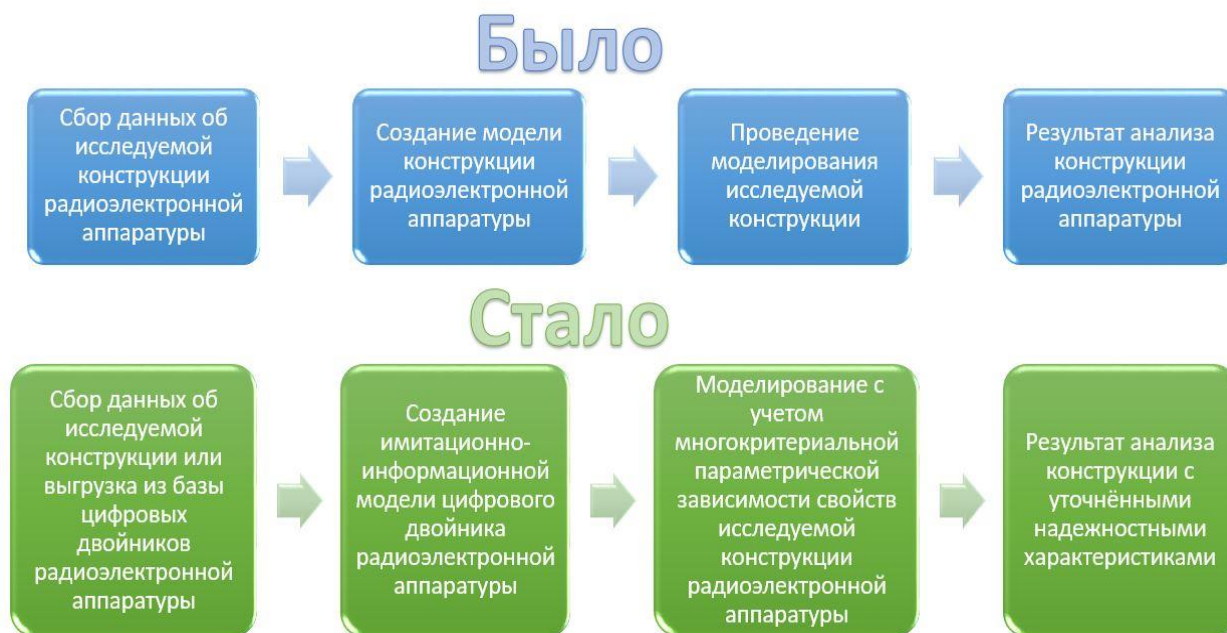
Рисунок 2 Метод анализа конструкций радиоэлектронной аппаратуры с учетом многокритериальной параметрической зависимости свойств исследуемой конструкции
