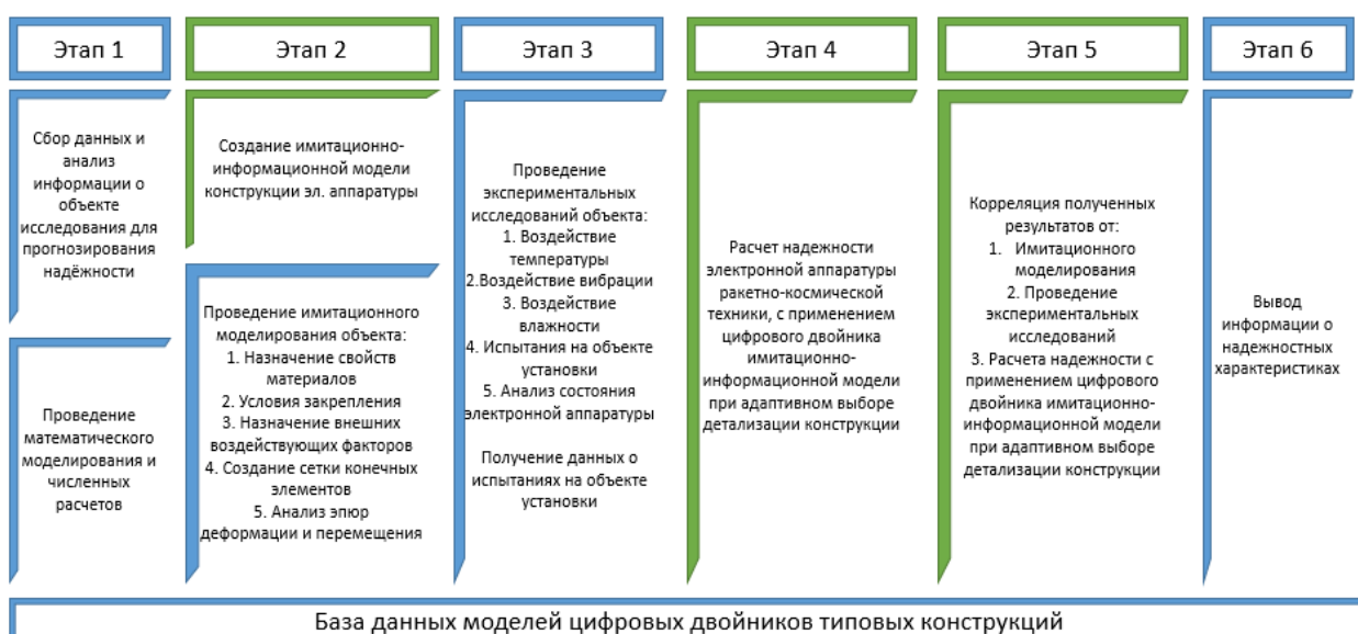
Рисунок 8 Методика прогнозирования надежности радиоэлектронной аппаратуры ракетно-космической техники
