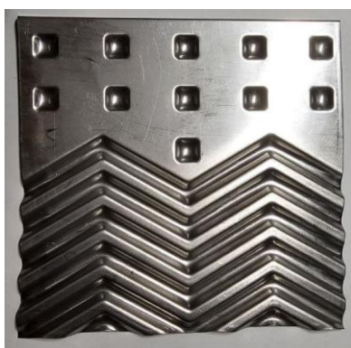
Рисунок 7. Элементы пластины теплообменника, полученные при формовке в закрытом объеме полиуретаном ПФЛ-100-S
