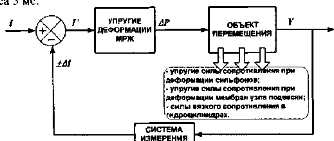
Рис. 5. Структурная схема МР модуля в режиме точной регулировки положения
