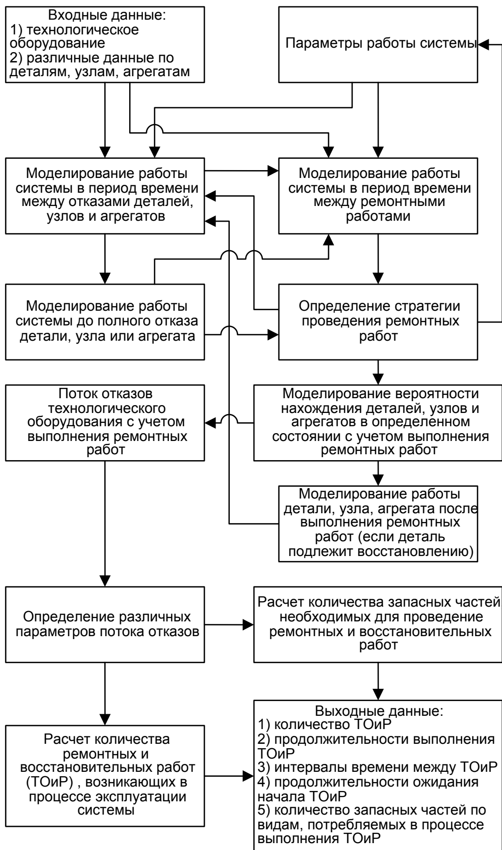
Рис.2. Блок-схема моделирования процесса возникновения отказов при эксплуатации технологического оборудования.
