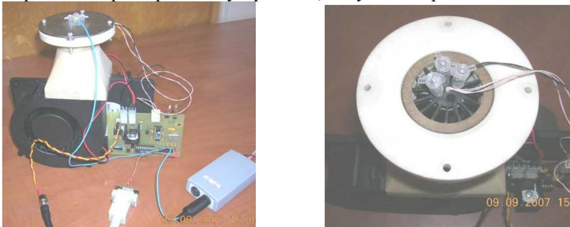
Рис. 15. Макетный образец теплового блока анализатора нуклеиновых кислот
