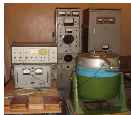
Рис. 8. Экспериментальная установка. (а) схема, (б) общий вид: 1- Упругая балка; 2- Вибратор ВЭДС–200; 3- Масса; 4- Маятник; 5- Пьезоэлектрический акселерометр; 6- Генератор сигналов; 7, 8- Датчики ускорения KD35
