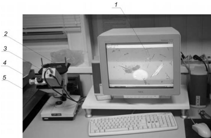
Рис. 9 – Стенд для анализа частиц износа сепаратора в смазывающем масле ТМН: 1 – Изображение с микроскопа, 2 – Образец масла ТМН, 3 – Фото-видео камера микроскопа, 4 – Микрометр окулярный винтовой МОВ-1-16х; 5 – Микроскоп.
