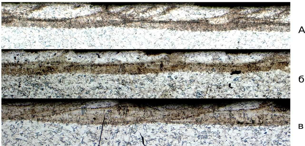
рис.7. Макрошлифы сварного соединения при различных соотношениях времени сварки к времени паузы
