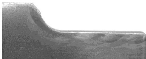
Рис.6. Макрошлиф продольного сечения образца после ЭКНП 3-х слоев и дуговой наплавки галтели
