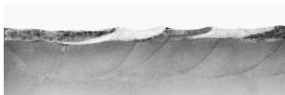
Рис.3. Макрошлиф образца после ЭЖНП проволоками Нп-30ХГСА и 40Х13
