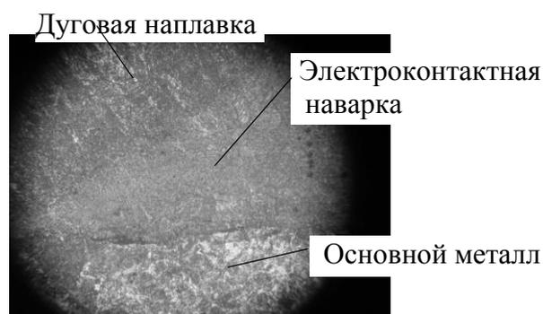
Рис.7. Микросшлиф области галтельного перехода (x350)
