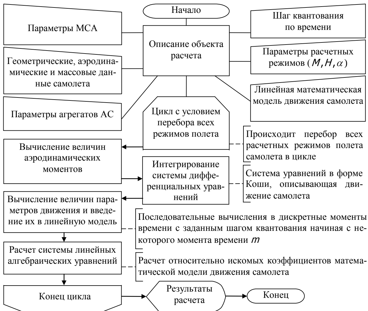
Рисунок 2. Блок-схема алгоритма вычисления параметров математической модели движения самолета
