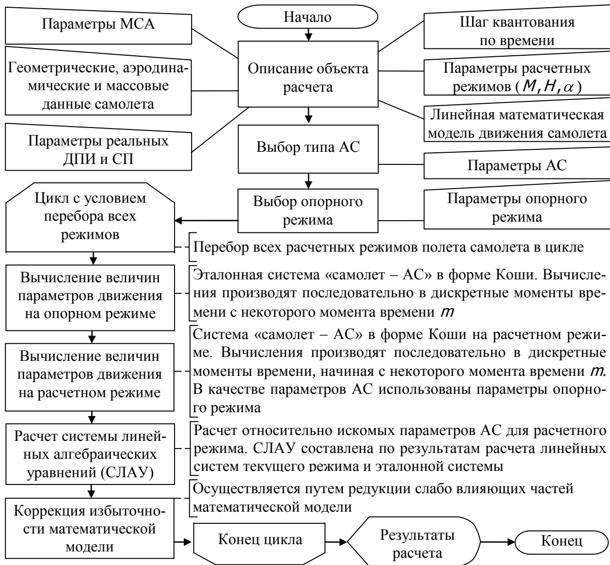
Рисунок 4. Блок-схема алгоритма вычисления параметров АС на стационарных режимах полета самолета
