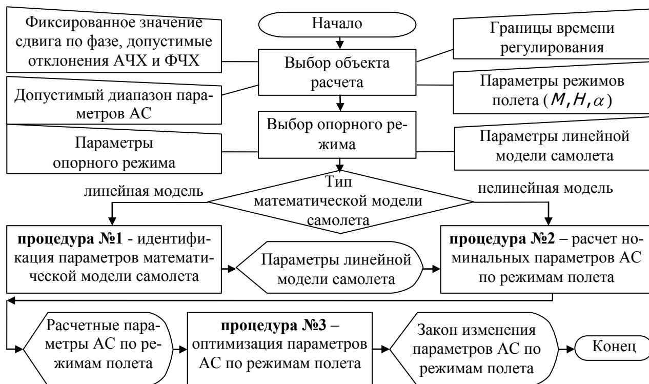
Рисунок 8. Блок-схема алгоритма синтеза АУ САС
