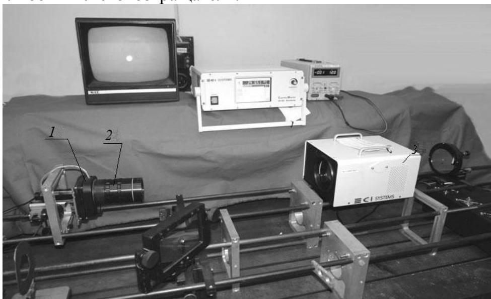
Рис. 9. Модификация измерительного стенда, предназначенная для работы с тепловым имитатором ретроотраженного излучения (1 - матричное фотоприемное устройство длинноволнового ИК диапазона, 2 - фотообъектив, 3 - тепловой имитатор ретроотраженного излучения на базе ЧТ и коллиматора фирмы CI-systems)
