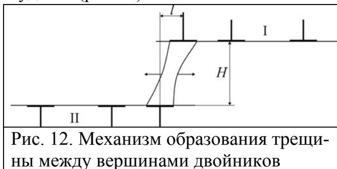
Рис. 12. Механизм образования трещины между вершинами двойников
