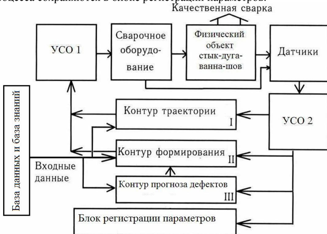
Рис. 2. Структурная схема трехконтурной системы управления аргонодуговой сваркой. УСО – устройство связи с объектом
