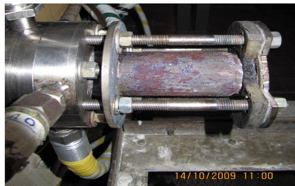
Рис. 11. Модельная втулка из КМ C-C/(Si-C-N) после 3-х циклов испытаний, закрепленная на плазмотроне «Звезда»
