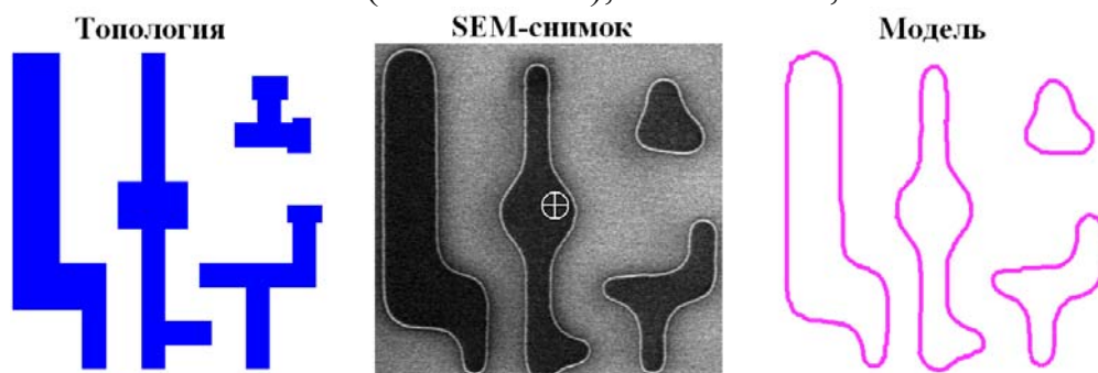
Рис. 12. Пример верификации по сложному топологическому контуру
