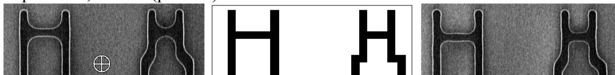
Рис. 14. Фрагменты топологии «Н-транзистора» и травленые ТС с ОРС и без
