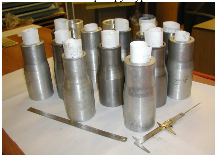
Рис. 9. Отштампованные детали из сплава АД1 и стали 40ХН
