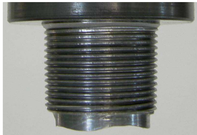
Рис. 12. Образец Н14, винтовой пуансон, \alpha = 20 , d = 44 мм, h = 35,3 мм, P = 0,42 МН
