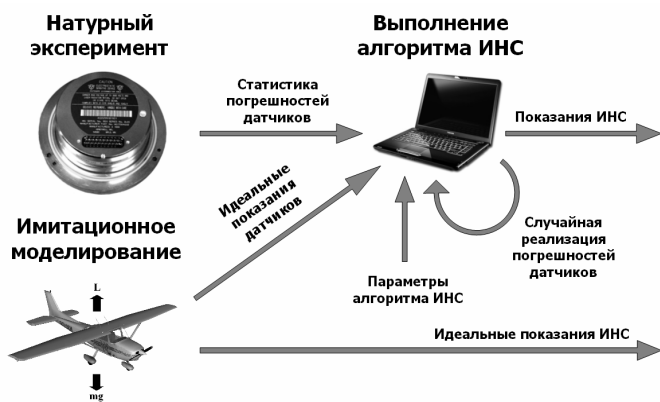
Рис. 2. Схема полунатурных испытаний ИНС
