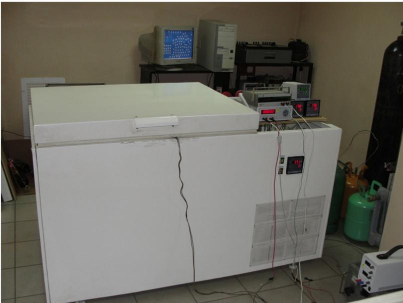
Рис. 4. Внешний вид экспериментального стенда для исследования динамических характеристик ПКХМ на многокомпонентных смесях хладагентов
