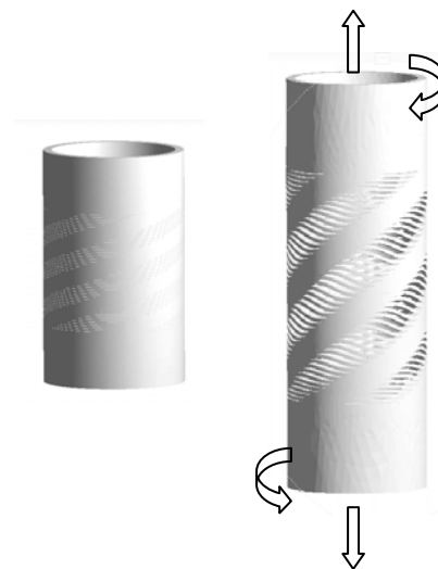
Рис. 3. Принцип регулирования ширины щелей путем изменения длины фильтроэлемента
