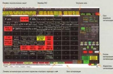
**4** Размещение сигнальных табло на экране АРМ оператора ПТК "САРГОН"
