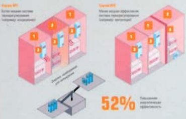
20 Пример шкафа, содержащего несколько потребителей с разной тепловой нагрузкой
