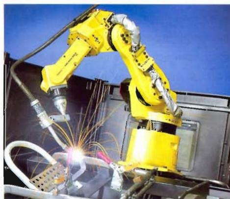
**Стр. 41** Использование роботов для дуговой сварки (MIG/MAG, TIG сварка) в ближайшее время может достичь наибольшего роста, а также произойдет значительное увеличение использования роботов для лазерной сварки и гибридных технологий
