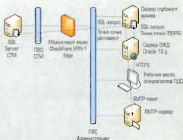
**4** Пример реализации защищённого доступа к данным систем технологического управления
