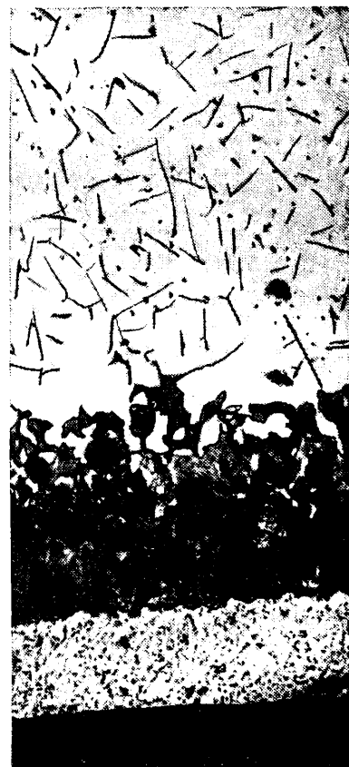
Рис. 5. Микроструктура азотированного слоя. Температура азотизации 650^{\circ} . Охлаждение после азотизации в масло.
