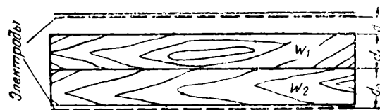
Рис. 10. Эскиз последовательного включения двух образцов древесины
