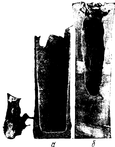
Рис. 12. Разрез отливки из быстрорежущей стали; продолжительность кристаллизации а — 3 мин.; б — 4,5 мин.
