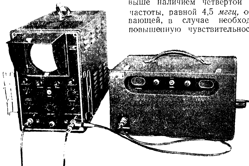
Рис. 3. Импульсный ультразвуковой дефектоскоп 86ИМ-3, позволяющий осуществлять работу на две и на одну искательную головку
