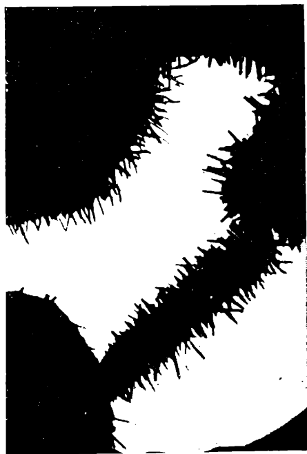
Рис. 2. Образование игл на контуре порошка вольфрама (рис. 1) под действием электронного пучка в течение 40 сек. \times 14\,000
