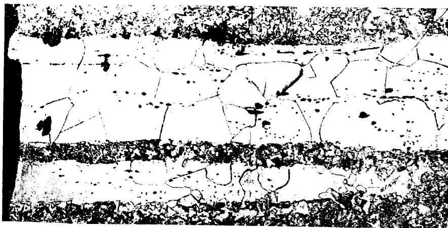
Рис. 3. Светловина — раскатанный газовый пузырь, заполненный сегрегатом. Травление 4%-ной \text{HNO}_3 . \times 100
