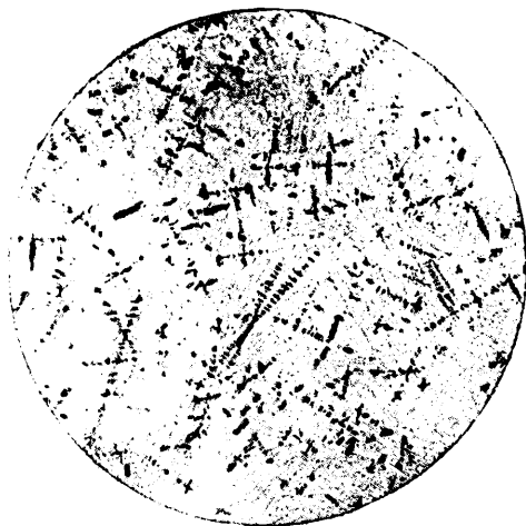
Рис. 3. Микроструктура пробы диаметром 5,5 мм. \times 50
