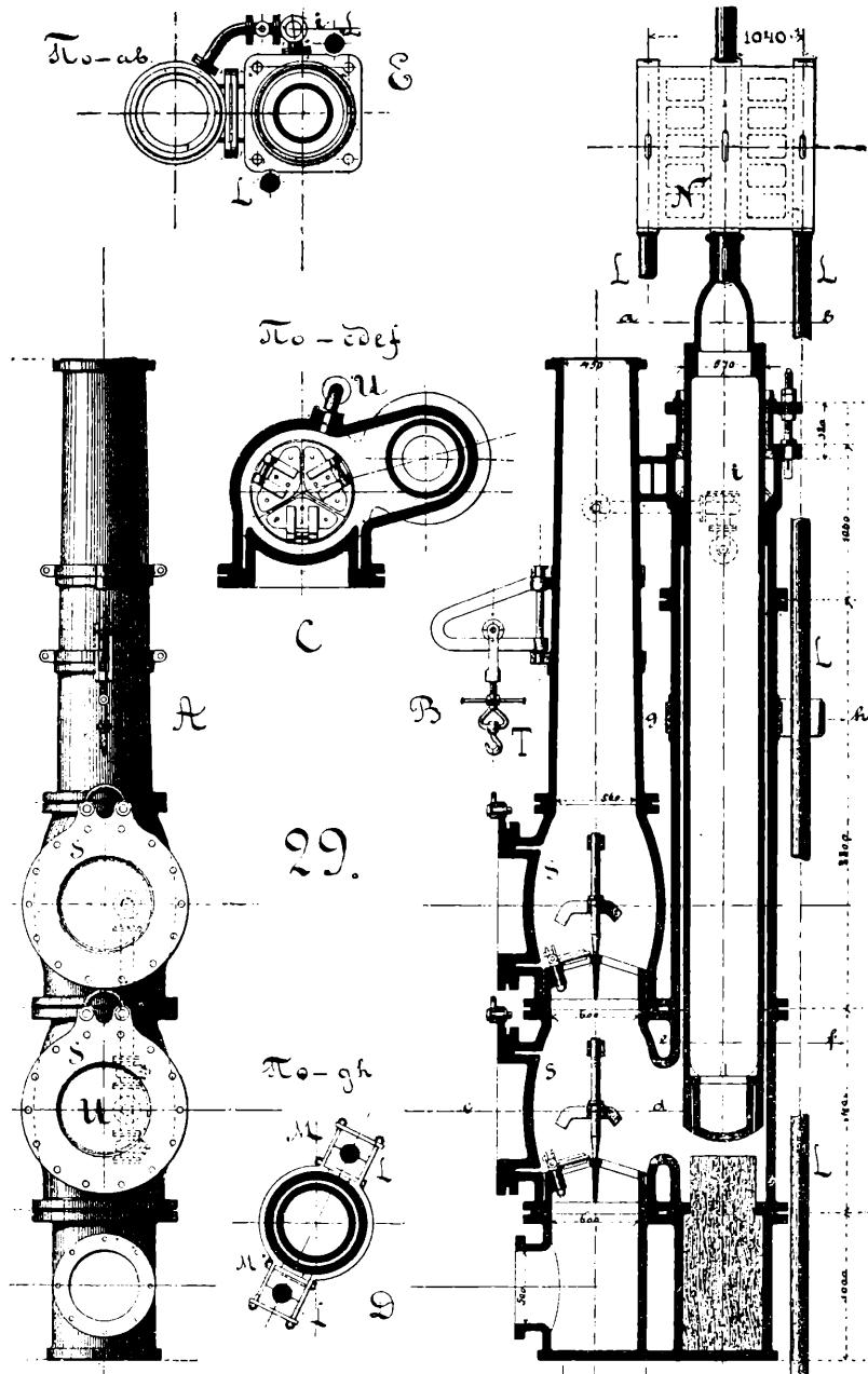
плоскостяхъ: ось насоснаго цилиндра—въ плоскости вращенія эксцентрика, а ось золотниковаго стержня въ другой вертикальной плоскости; вся передача должна работать съ ударами и поперекъ, что совершенно не гармонирует съ назначениемъ парораспределительного механизма.
