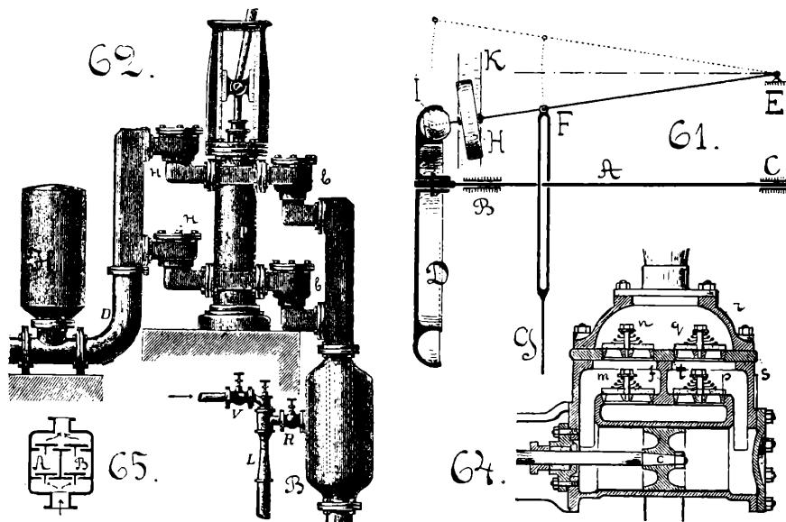
**K:** шаръ **I** соединенъ съ цилиндрическимъ лѣвымъ концомъ рычага **EF** такъ, что онъ можетъ имѣть еще движение и вдоль оси рычага, когда это будетъ необходимо: на шарнирномъ болѣ **F** подвѣшенъ поводокъ **FG**, идущій къ насосному поршню; верхняя часть этого поводка снаб-
