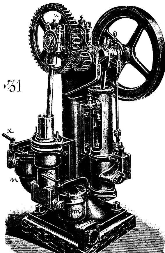
изображена модель парового насоса съ зѣбчатой передачей; большее изъ колесъ ея снабжено дискомъ *u*, по которому палецъ кривошипа можно
