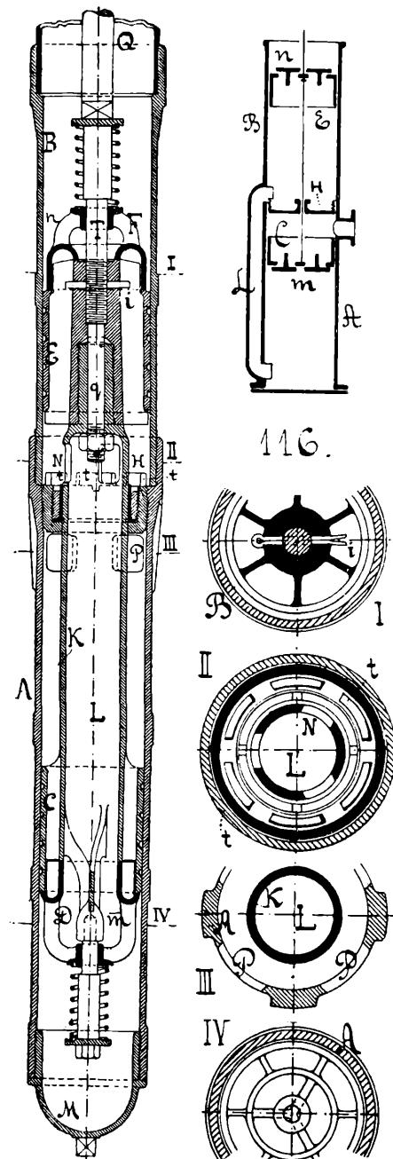
Дно *H* выполнено такимъ образомъ, чтобы его можно было отвертывать и вынимать, воздѣйствуя на штангу *Q*; безъ этого, разумѣется, нельзя вынуть и поршней изъ цилиндровъ для осмотра клапановъ. Дно *H* на верхнемъ своемъ торцѣ спабжено выступами *t*; совершение такие
