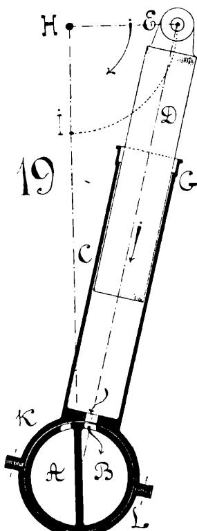
въ это время каналъ на дѣлѣ цилиндра будетъ стоять какъ разъ противъ перегородки у трубы **AB**, а цилиндръ будетъ разобщенъ съ обоими отѣсненіями этой трубы. Затѣмъ начнется подъемъ плунжера, ось цилиндра **C** начнетъ отклоняться вълево отъ вертикали, тотчасъ же постѣдуется сообщеніе цилиндра **C** съ отѣсненіемъ **A** и присасываніе жидкости въ цилиндръ.
