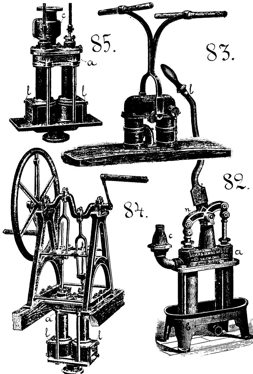
При различной величинѣ діаметровъ цилиндра (отъ 2 до 5 дм.) заводъ оставляетъ обыкновенно ходъ поршня одинъ и тотъ же —  $S=9$  дюйм. Примѣненіе такихъ насосовъ къ качкѣ воды изъ колодцевъ ручнымъ приводомъ и коннымъ хорошо объясняетъ **фиг. 86.** Чтобы удобно было осматривать клапаны по снятіи крышекъ *l*, при насосѣ
