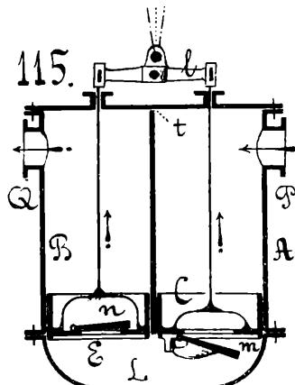
одно цѣлое, а каналъ *L* расположень сбоку и соединяетъ нижнія части обоихъ цилиндровъ. Между ними необходимо здѣсь имѣть промежуточное дно *H* и въ немъ—сальникъ. Перестроивши такимъ образомъ предыдущую схему, получаемъ новую, которая была изобрѣтена и патентована въ 1896 г. *Винкелемъ*. Конструктивная разработка этой схемы имѣеть некоторое значеніе въ примѣненіи къ устройству артезіанскихъ насосовъ: здѣсь, какъ и въ насосѣ *Константинова*, штангъ одна, хотя оба эти насоса двойного дѣйствія.
