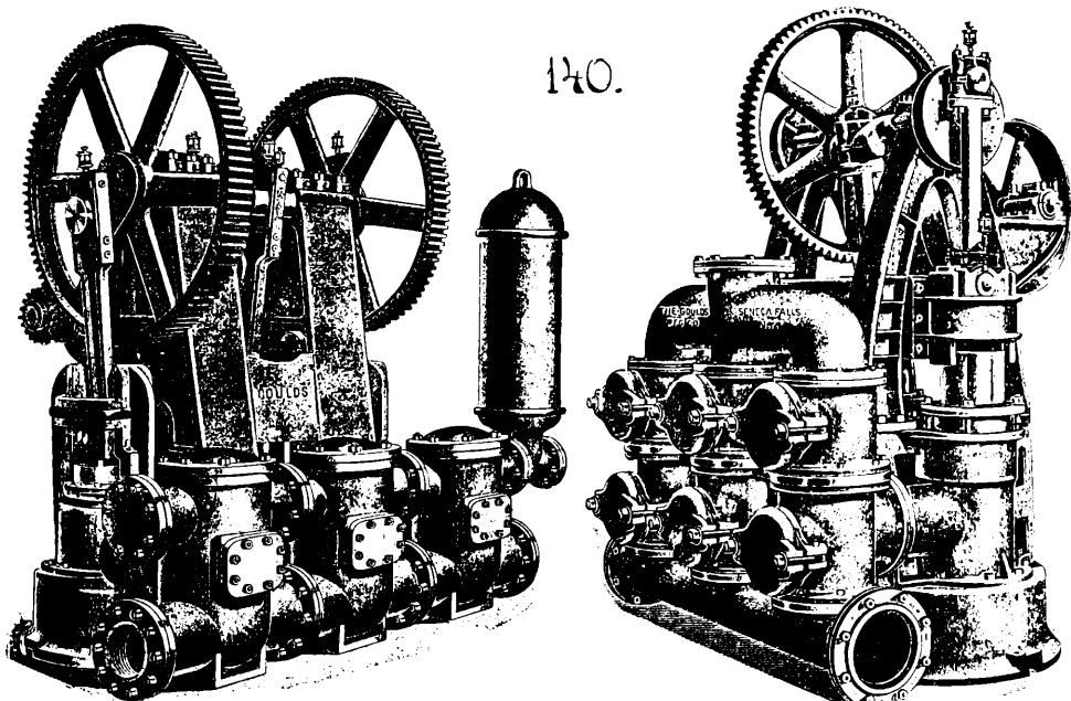
сосовъ всасывающій и нагнетательный клапаны помѣщены въ одной общей коробкѣ, но она повторяется во всемъ устройствѣ 3 раза, а въ правомъ типѣ — и всасывающій клапанъ и нагнетательный при каждомъ насосѣ расположены въ отдѣльныхъ коробкахъ, свинченныхъ между собою; доступъ ко всѣмъ клапанамъ совершенно свободный, для осмотра
