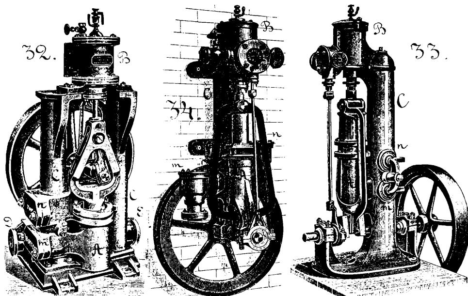
низмы, въ которыхъ ползуны отсутствуютъ, и роль ихъ вынадаетъ тогда на долю сальниковъ съ большими боковыми опорными поверхностями. Три различныхъ пріемѣра подобного устройства изображены на фиг. 32—34.
