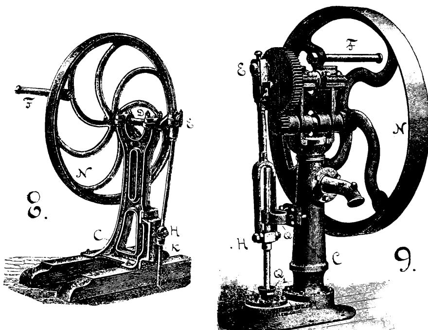
На **фиг. 8** имѣемъ весьма простое устройство станка съ опредѣ-
