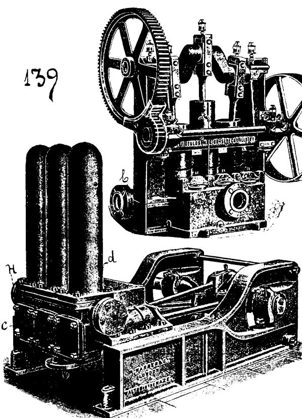
ражение даетъ понятіе объ устройствѣ насосовъ англійскаго зав. *Warner & Co.*; для осмотра всасывающихъ клапановъ здѣсь отнимаются з заднія крышки *c*, а для осмотра нагнетательныхъ клапановъ — з колпака *d*, объемъ которыхъ, кстати сказать, здѣсь излишне развить: нагнетательной трубы *n* отнимать при этомъ не приходится.
