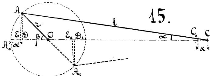
Схема передачи изображена на **фиг. 15**:  $O$  — центръ вала,  $AO$  — кривошипъ длиною  $r$ ,  $AC$  — шатунъ длиною  $l$ ,  $OC$  — направление оси насоснаго цилиндра,  $C$  — положеніе центра ползуунаго болта въ то-
