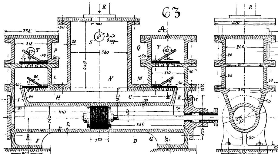
опубликовала мною въ *Техническомъ Сборнике* (1892 г., № 4, стр. 157): слѣва данъ продольный вертикальный разрѣзъ насоса, а справа — по-переченный по линіи *ABCD*; *N* — холодильникъ; труба *R* приводить въ него отработавшій въ машинѣ паръ, а труба *S* — холодную воду; оси этихъ трубъ взаимно перпендикулярны; *H* — каналъ, который ведеть
