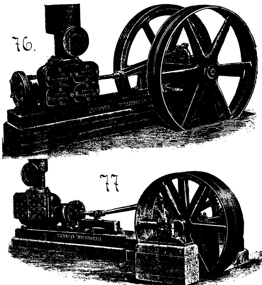
По типу фиг. 76 насосы строятся съ діаметромъ въ 3, 4, 5, 6, 7 и 8 дм., при  $S = 12$  дм. и  $n = 40$ ; діаметръ маховика — отъ 30 до 54 дм.
