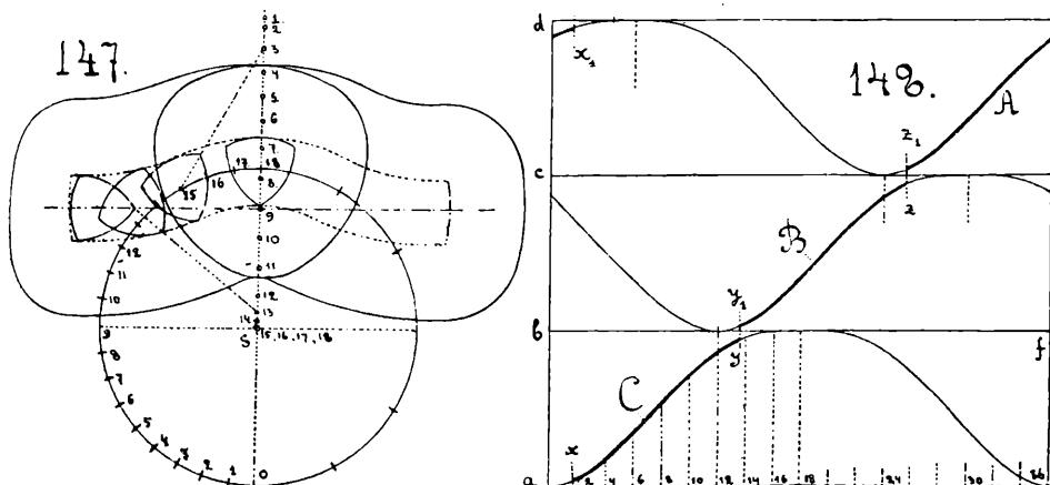
Проекція кривой  $xy$  (фиг. 148) на вертикаль представляетъ собою рабочій размахъ одного изъ поршней. Повторяя его 3 раза и умножая эту сумму на площасть сѣченія цилиндра, получимъ полныи объемъ жидкости, подаваемый за 1 оборотъ вала. Но *Busley* въ насосахъ *Downton* величина этого объема можетъ быть такою:
