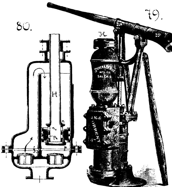
**51. Насосы съ клапанами, размѣщенными въ двухъ коробкахъ.** Обѣ постѣнія отливаются по одной модели. Присоединеніе такихъ коробокъ къ цилиндрю одинаково удобно дѣлается какъ при горизонтальной оси у него, такъ и при вертикальной. Проходныя сѣченія въ коробкахъ и у клапановъ можно при этомъ развивать довольно значительно, не рискуя особенно сильно увеличить чрезъ это объемы вредныхъ пространствъ у цилиндра.
