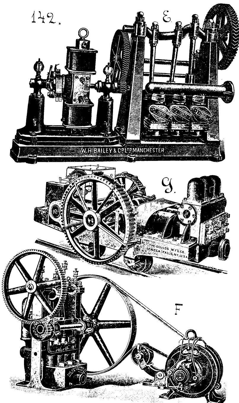
насосовъ съ электрической передачей промежуточныя зубчатыя передачи вовсе выброшены, у насоса и электромотора—общій валъ, который за-
