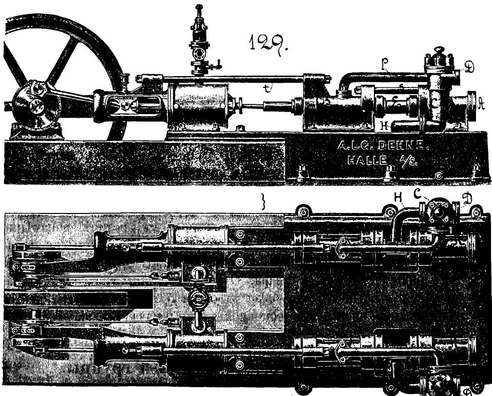
На фиг. 129 изображена комбинація насосовъ съ паровою машиной просто сдвоенною, по она можетъ быть поставлена и типа компаундъ при желаніи работать болѣе экономично по отношенію къ расходу топлива.
