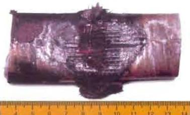
**10** Фрагменты стержня обмотки поврежденного электродвигателя СТД-12500-2 ЭГПА 1 КЦ "Ямбург-Елец-2" КС-24 "Сеченовская"
