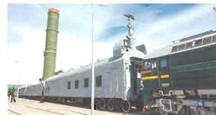
Каким видится боевой железнодорожный ракетный комплекс (БЖРК) «Баргузин»? К примеру, хорошо отработанная ракета РС-24 «Ярс» при длине 22,4 м и массе 50 т без особых трудностей может быть размещена на одной железнодорожной платформе и стать основой комплекса.
