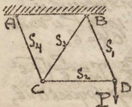
234. К пологому косяку помешаны в точках  $A$  и  $B$  при помощи шарниров присоединены два равных стержня, толщина  $a$ , равной  $AB$ ; такие же два стержня соединены между собой при помощи
