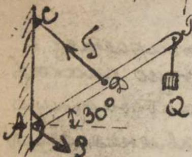
ся кинетою DC, перпендикулярной к AB. Угол при点儿 AB с горизонтом равен  $30^\circ$ . Определить сопротивление б токах A и C при равновесии.
