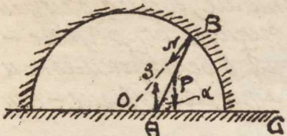
китцкой полусфере, центр которой на АС. Найти горизонтальную силу  $Q$ , которую надо приложить в А, чтобы удержать брускок в данном положении, при угле наклона к горизонту  $= \alpha$ ; вычислить давление  $N$  на сферу и на плоскость  $B$ .
