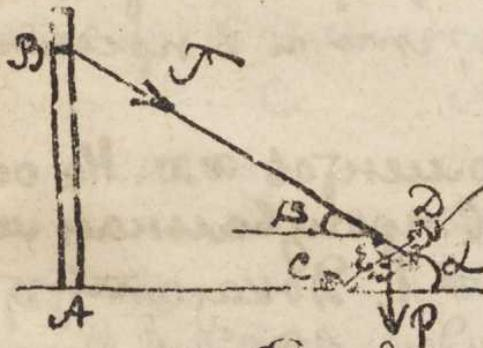
Длина веревки (+ рука)  $BD = \ell$ ; длина человека от пяток до пир.  $AD = h$ ; расстояние центра тяжести от пяток  $CE = a$ ; расстояние балки С от стены может быть выбрано по произволу. Найти наибольшее угол наклона человека ( $\alpha$ ) и веревки ( $\beta$ ) к горизонту. Наибольшее усилие Т, какое может развернуть человек, складывается определяется статическим условием равновесия, а затем мускульной силой человека и тогда равно  $T_{\max} = Q = nP$  (обычно тройной вес человека, т.е.
