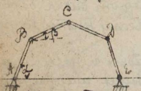
на соединении шарниром через одну, и вся система находиться в равновесии, опираясь в точках  $A$  и  $A'$ . Отрезки  $AB$  и  $A'B'$  имеют веса  $P$  и  $Q$ , пропорциональные их длинам. Определить напряжение  $t$  и натяжение  $\tau$  шарниров  $AC$  и  $B'C'$  и давление  $p$  и  $q$  в точках  $B$  и  $C$ , предполагая, что система расположена симметрично относительно  $CD$ ; весы шарниров пренебречь.
