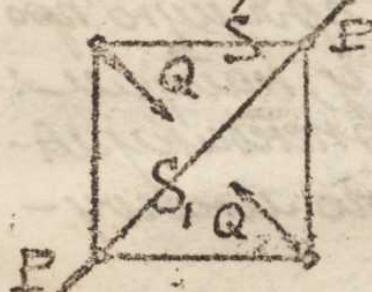
стержневых сторон шарнирного квадрата под зеркально действующих сил  $P, P$  и симметричных  $Q, Q$ , действующих на его противоположные вершины.
