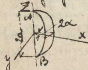
$$\text{Отв. } \alpha = \frac{3}{16}\pi a \frac{\sin \alpha}{\alpha}; \bar{z} = 0; \text{ для полушара } \bar{x} = \frac{3}{8}a.$$
