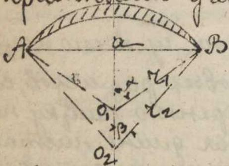
поперечного сечения именем кривой аэродинамов "Ампера", откуда эта фигура и получила свое название. В частном случае, когда нижний контур образуется в прямую линию ( $\beta=0$ ,  $r_2=\infty$ ), фигура образуется в круговой сегмент и в авиацииносит название, дужки Ратто" (по имени ученого, исследовавшего эту форму в аэродинамической аэrodинамике). [Н. Е. Жуковский].
