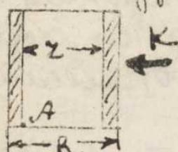
Определить наружный диаметр  $R$ , если нужно, чтобы равнодействующая сила проходила через точку  $A$  основания. Все единицы измерения = дм.
