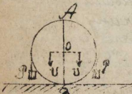
Груз диск перекинута линия, концом которой свешивается с диска и обрашеннем вправо висят грузы  $P$ . Диск разрезает столбом по вертикальноому диаметру  $AB$ . Каково наименьшее значение грузов  $P$ , при которых половина диска не разваливается?
