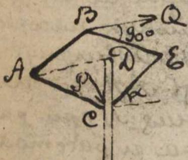
образует с горизонтом угол  $\alpha = 30^\circ$ . На точку B действует под прямым углом к BC горизонтальная сила  $Q = 5$ , а на точку C сила  $P = 4$ , перпендикулярная доске. Доска подпирается в точке D на расстоянии от A = 3.
