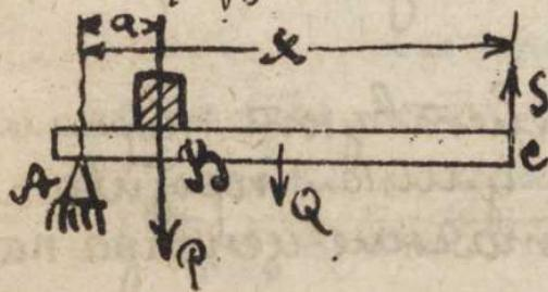
расстоянии  $2$  фут. от опоры  $A$ , нужно поднять силой  $S$ , приложенной к другому концу рычага ( $C$ ). Положив вес рычага  $q = 10$  фунт. (ес.),
