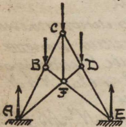
рашающаяся в точках А и Е на неподвижные опоры, подверженная действию вертикальных сил  $P_1, P_2, P_3$ . Ферма составлена из отдельных брусков, соединенных в точках А, В, С, Д, Е и F шарнирами. Определить гравостатическое напряжение в китоевом бруске CF и построить для всей фермы диаграмму Крамока.
