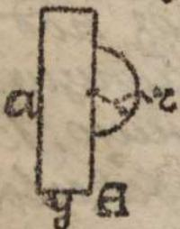
Определить такое  $y$ , чтобы коробка стояла на столе, опираясь на свой край A. Поверхность плотности всегда одинакова.
