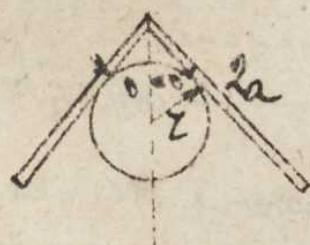
динамом маркиром в точке A. Стержень AO укреплен в точке вращения O, а стержень AB опирается краем об угол B. Дать OA : OB. Определить угол  $\varphi$  при равновесии.
