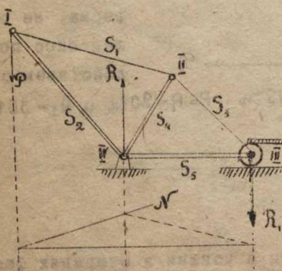
N 144. Определить усилия стержней параболической фермы, загруженной грузами:  $P_1 = \frac{P_2}{2} = \frac{P_3}{2} = \frac{P_4}{2} = P_5$
