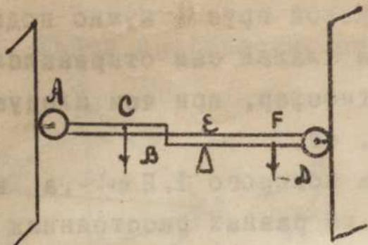
длиною в 12 м<sup>м</sup> весом 0,8 тн, которая подперта в точке  $E$  и соединена со стеной шарниром  $D$ . В точках  $C$  и  $F$  помещены грузы по 0,4 тн каждый. Расстояния  $AC = 12 \text{ м}^m$ ,  $ED = 8 \text{ м}^m$ ,  $FD = 4 \text{ м}^m$ . Определить опорные реакции.
