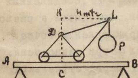
вес груза  $P$ , вес балки  $A B = 3$  т, вылет крана  $KL = 4$  м. Найти опорные реакции в точках  $A$  и  $B$  при том положении крана, когда он находится в одной вертикальной плоскости с балкой  $AB$  и расстояние  $AC = 3$  м.
