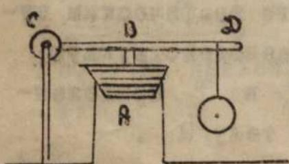
клапана  $A = 6$  ст.,  $B C = 7$  ст. Какой груз  $Q$  нужно подвесить к концу  $D$  рычага, чтобы клапан сам открывался при давлении в котле в 11 атмосфер, при чем следует считать 1 атм. = 1 кг/ на кв. ст.
