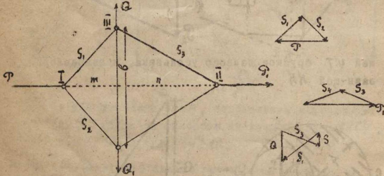
узлы фермы, рассматриваем условия равновесия узла под действием внешних сил и напряжений стержней. Рассмотрим узел I. На него действуют силы:  $T$  и напряжения стержней:  $S_1$  и  $S_2$ . Строим замкнутый силовой мн-к /черт. 31/. Определяем величины  $S_1$  и  $S_2$ . Строим силовой мн-к для узла II, определяем:  $S_3$  и  $S_4$ . Переходим к узлу III, на который действуют силы:  $Q$ ,  $S_1$ ,  $S_3$  и  $S_4$ , где  $S$  - напряжение стержня  $b$ . Строим силовой мн-к /черт. 33/ Опре-
