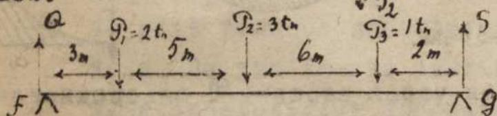
равномерно загружена нагрузкой  $1,5 \text{ t}_n$  на погонный метр. См. чертеж № 131
