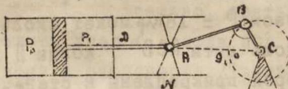
В паровой машине площадь поршня равна  $0,1$  кв.метр.; длина шатуна АВ 2 метр.; длина кривошипа ВС = 0,4 метр.; давление пара в цилиндре за поршнем  $P_0 = 6$  атм; перед поршнем  $P_1 = 1$  атм. Найти силу  $R$ , врачающую кривошип и давление  $M$  крейцкопфа  $f$  на направляющие параллели при том положении поршня, когда угол АВС =  $90^\circ$ . [1 атм = 1 кг/кв см. Трением между крейцкопфом и параллелями пренебрегаем.]
