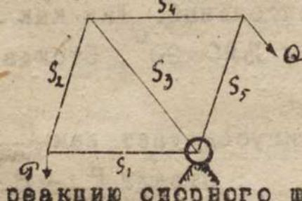
N 148. Имеющая форму квадрата, ферма закреплена в точке O шарниром и нагружена двумя силами P и Q параллельно диагоналям квадрата.
