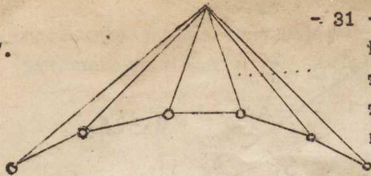
Найти графически центр тяжести линейного контура фермы, указанной на чертеже.
