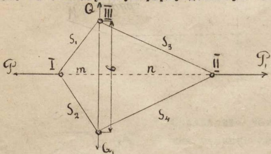
Определить силу натяжения в стержнях фермы.
