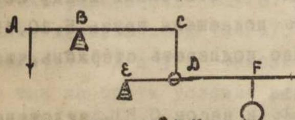
двух неравноплечих рычагов  $ABC$  и  $EDF$ , соединенных между собою тяжем  $CD$ . В точках  $B$  и  $E$  имеются неподвижные опоры.
