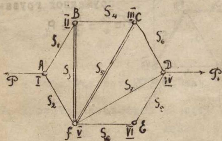
Найти напряжение стержней фермы без опор находящейся под действием сил  $P = P_i$ .
