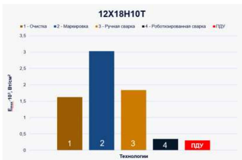
Рисунок 5. Графики уровней максимальной облучённости от ЛИ при различных технологических процессах обработки нержавеющей стали типа 12Х18Н10Т
