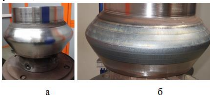
Рисунок 7. Внешний вид валка до легирования (а) и после легирования (б)
