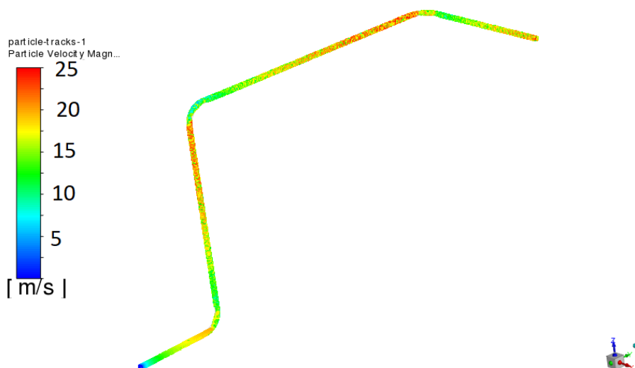
Рисунок 15. Распределение скорости частиц в процессе пневматической транспортировки
