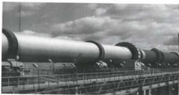
Рис. 1. Вращающаяся цементная печь
