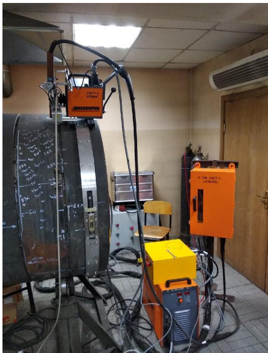
Рисунок 8. Разработанный комплекс для сварки неповоротных стыковых соединений труб
