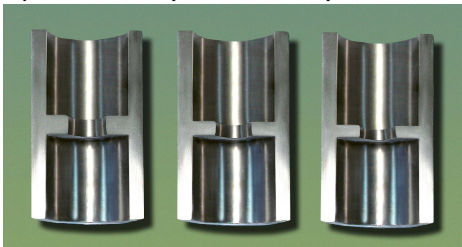
Рисунок 2. Выдавленные образцы из стали 10 R=15 мм, r=11 мм, r_0=5 мм, h=5, 4, 3 мм
