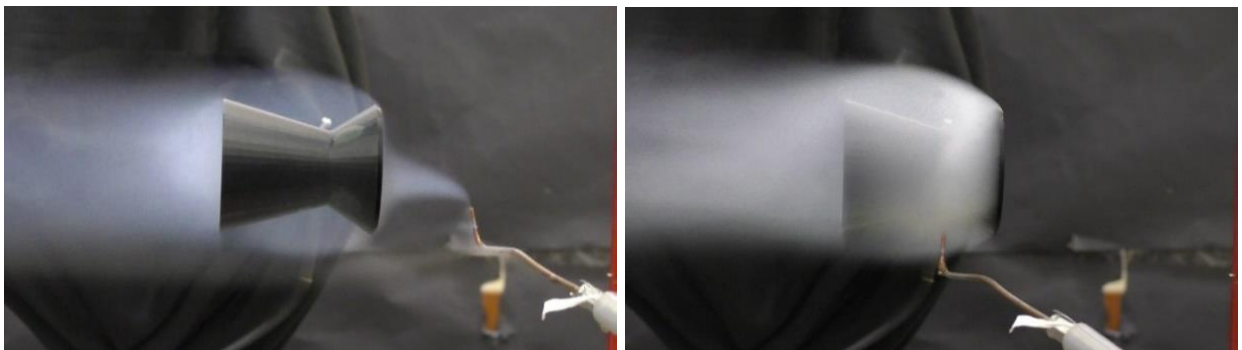
Рисунок 12. Визуализация обтекания пули типа ПА.1.06.0.00 потоком при скорости 15 м/с.
