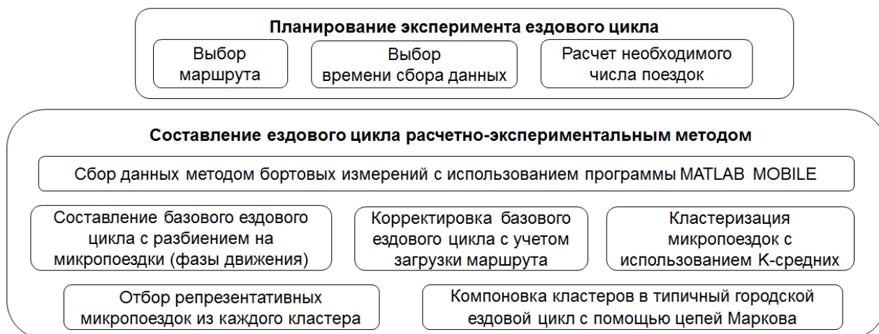
Рис.4. Блок-схема разработки типового городского ездового цикла
