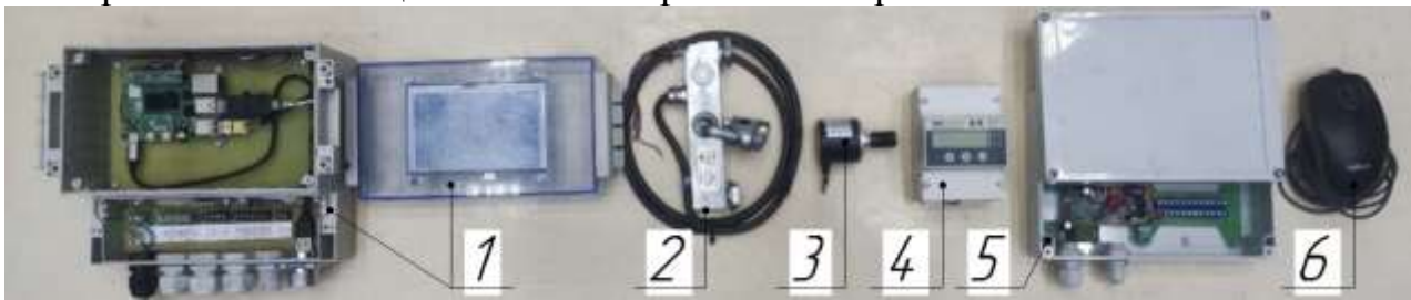
Рис. 3. Прототип прибора безопасности кранов мостового типа:
