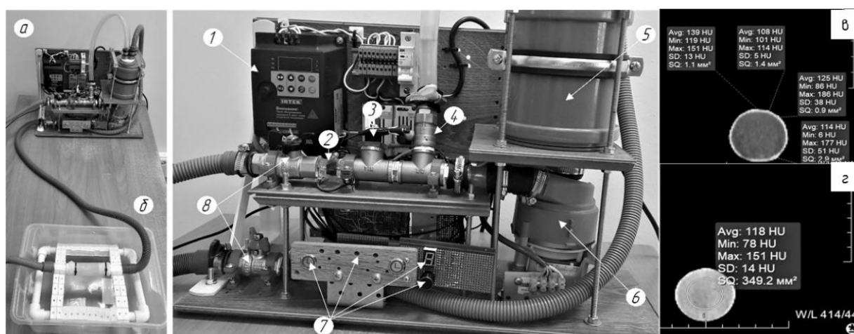
Рисунок 4. Лабораторный стенд, включающий генератор пульсаций (а) и тест-объект (б); генератор пульсаций включает: 1 – частотный преобразователь, 2 – расходомер, 3 – датчик давления, 4 – bypass, 5 – резервуар, 6 – насос, 7 – интерфейс пользователя, 8 – краны. Представлены бесконтрастная (в) и контрастно-усиленная (г) фазы сканирования тест-объекта
